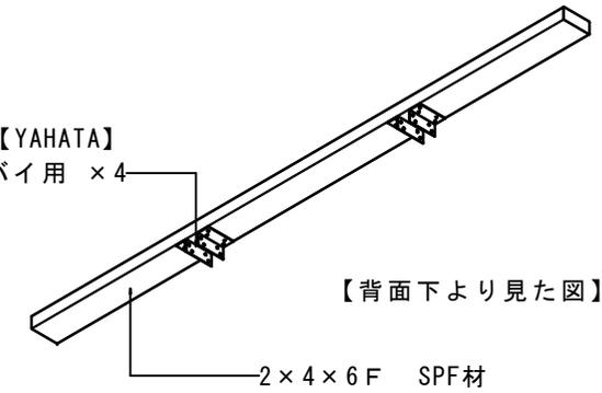
ディアウォール壁掛けテレビ AV機器ボード部品図 ①-4天板
