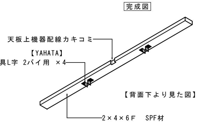
ディアウォール壁掛けテレビ AV機器ボード部品図 ①-2天板（はめ込み式）
