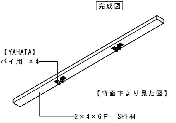
ディアウォール壁掛けテレビ AV機器ボード部品図 ①-3天板
