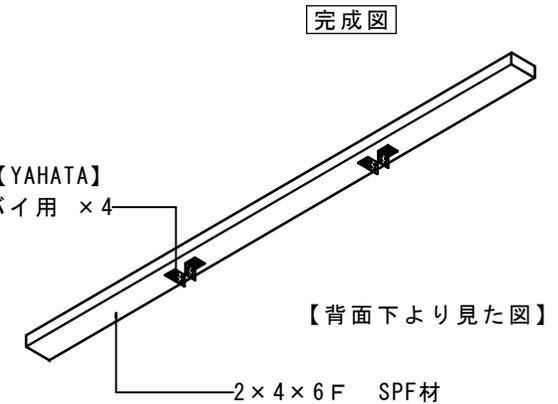
ディアウォール壁掛けテレビ AV機器ボード部品図 ①-3天板
